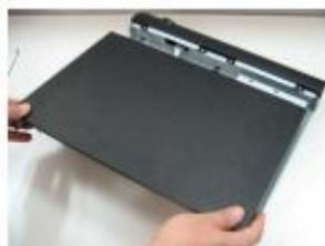
Открутите винты крепления крышки сзади и сбоку и снимите крышку.
