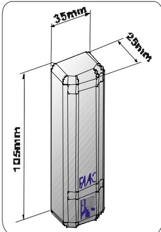
Фотодатчики SafeBeam – устройство безопасности, состоящее из инфракрасного передатчика и приемника. В случае пересечения инфракрасного луча переключается электрический контакт приемника.
