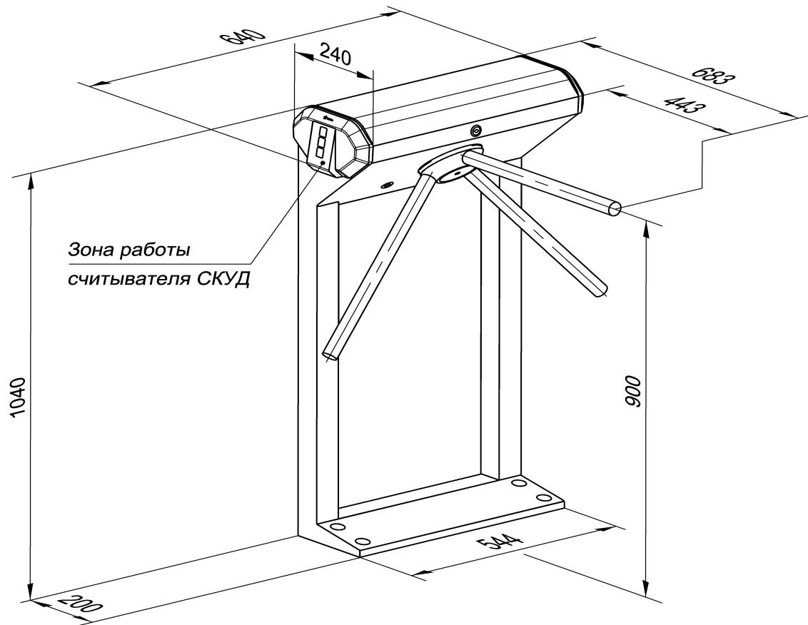
**Рисунок 2 – Габаритные размеры ЭП**
