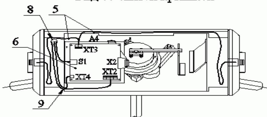
Рисунок 7 – Схема прокладки кабелей в стойке ЭП
